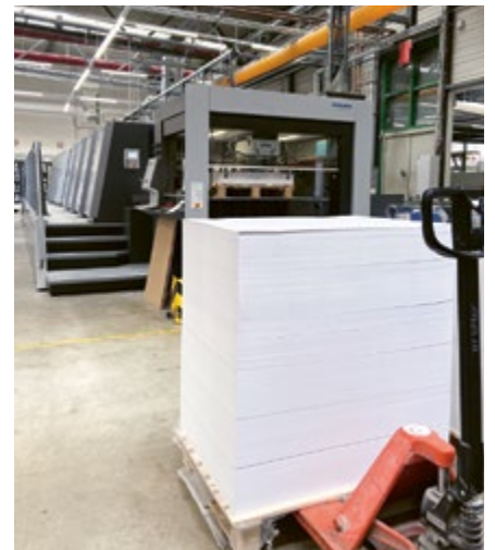
Das Papier liegt bereit. Die hochmoderne 8-Farbendruckmaschine druckt einen 16-seitigen Bogen beidseitig in einem Durchgang. In einer halben Stunde ist der erste von 2 Bögen der HannoRad gedruckt – immerhin 8.000 Stück.
